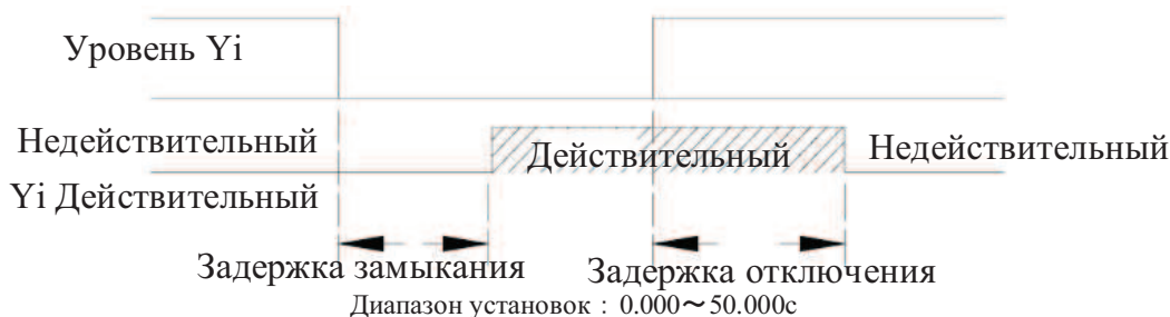
Рис.7-30 Схема работы многофункционального выходного терминала
