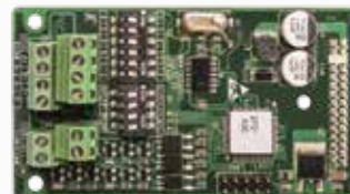
EPC-PG8 Применяется для подключения дифференциальных сигналов типа ABZ
