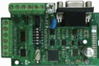
EPC-PG9 Применяется для подключения резольвера
