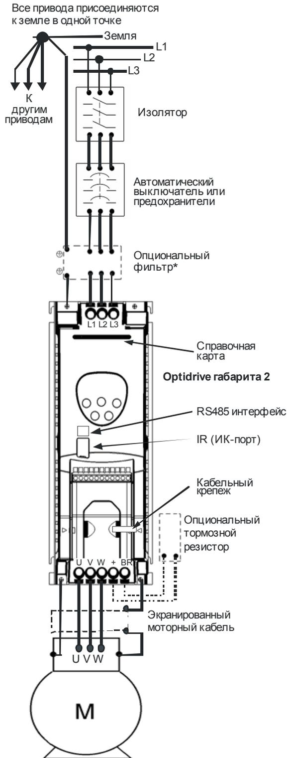
\* Если устанавливается фильтр, он должен быть смонтирован вплотную к приводу. Для максимальной эффективности металлический корпус фильтра и радиатор привода должны быть электрически соединены, т.е. должны быть скреплены обе задние металлические панели. Убедитесь в надежном контакте этих панелей.
