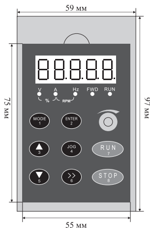
Установочные размеры панели
