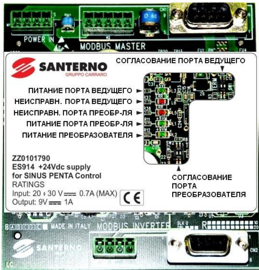
Рис. 173: Положение светодиодов и DIP-переключателей на плате ES914
