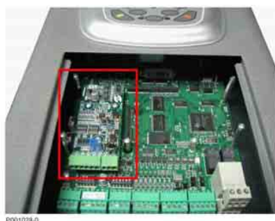
Рис. 107: Плата датчика, установленная в преобразователь
