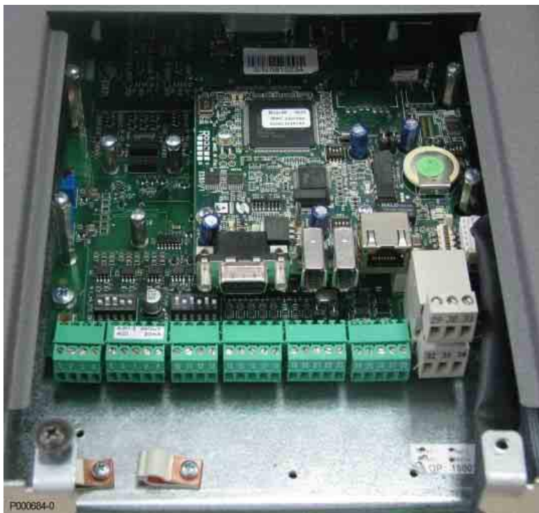
Рис. 152: Плата ES851 DataLogger, установленная в слот В
