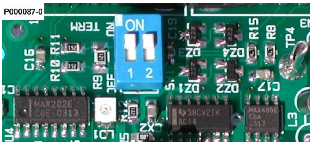
Рис. 122: Переключатели согласующего резистора интерфейса RS485
