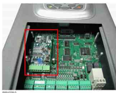
Рис. 116: Плата датчика, установленная в преобразователь
