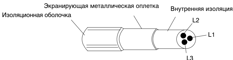
Рисунок 79 Эффективное экранирование кабеля электродвигателя (например, кабели Ciflex-Servo-FD 780 CP, Lappkabel или MССМК, НК).
