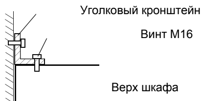
Крепление шкафа сверху с использованием уголковых кронштейнов (вид сбоку)
