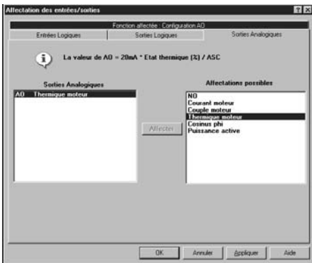
Назначение аналогового выхода с помощью ПО PowerSuite на ПК
