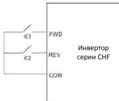
Рисунок 6.12. Двухпроводное управление режим 2.
