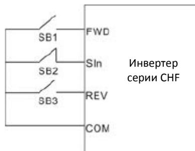
Рисунок 6.14. Трехпроводное управление режим 2.
