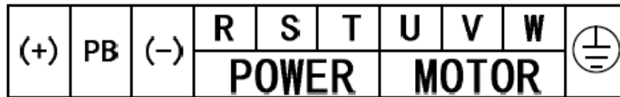
Рисунок 4.8. Клеммы силовой цепи (4–5,5 кВт)
