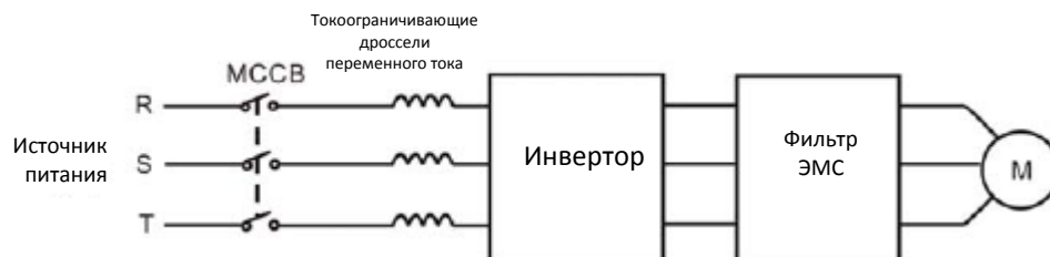
Рисунок 4.18. Электромонтаж силовой цепи электродвигателя
