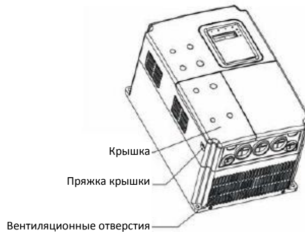
Рисунок 1.2. Компоненты инверторов (15 кВт и меньше)
