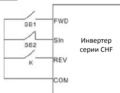
Рисунок 6.13. Трехпроводное управление режим 1.
