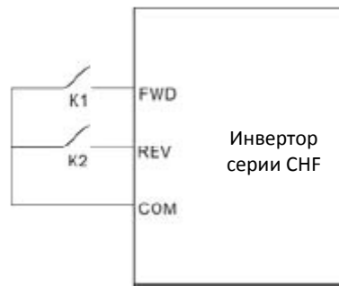
Рисунок 6.11. Двухпроводное управление режим 1.
