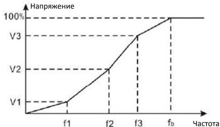
Рисунок 6.10. Установка параметров для пользовательской вольт-частотной характеристики
