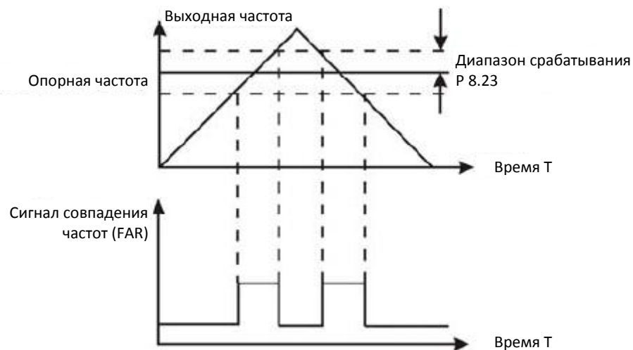
Рисунок 6.22. График сигнала совпадения частот (FAR).
