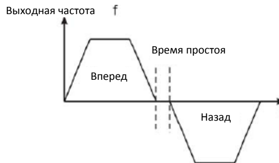
Рисунок 6.5. График задержки переключения вперед-назад (FWD/REV)
