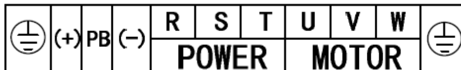
Рисунок 4.9. Клеммы силовой цепи (7,5 кВт)
