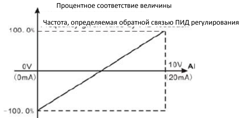
Рисунок 6.15. Отношение между сигналом аналогового входа AI и соответствующей величиной.
