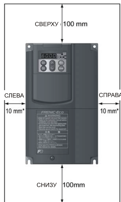
* 50 мм для ПЧ мощностью 90 кВт и выше Рисунок 2.1 Минимальные зазоры при установке ПЧ
