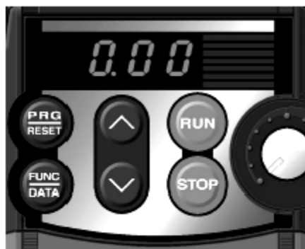
Рис.4.2. Показание СД дисплея после включения питания.
