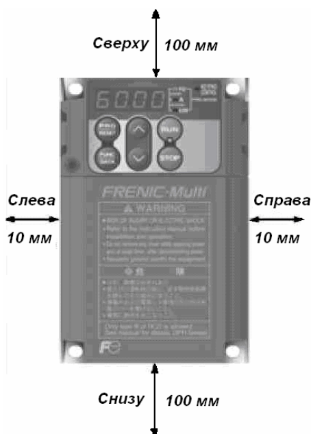
Рисунок 2.1 Положение при установке и необходимые зазоры
