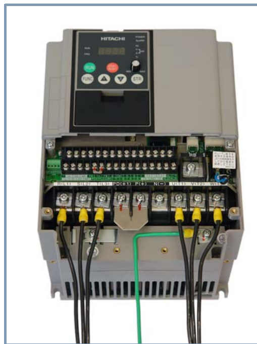
Источник питания Заземление К мотору
