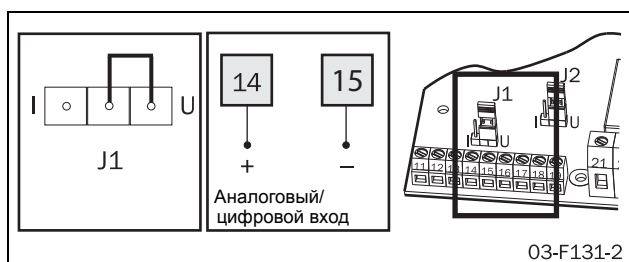
Рис. 55 Подключение для аналогового/цифрового входа и настройка переключки J1 для аналогового контроля силы тока или напряжения.
