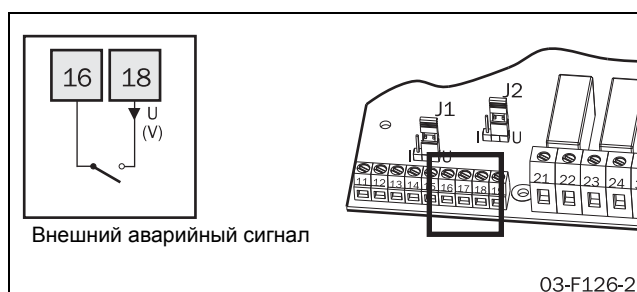
Рис. 68 Соединение клемм для внешнего аварийного сигнала
