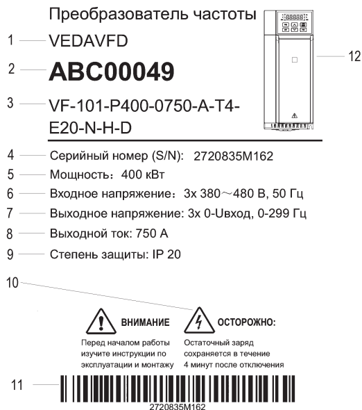
Рисунок 1.3-1. Пример маркировки преобразователя частоты
