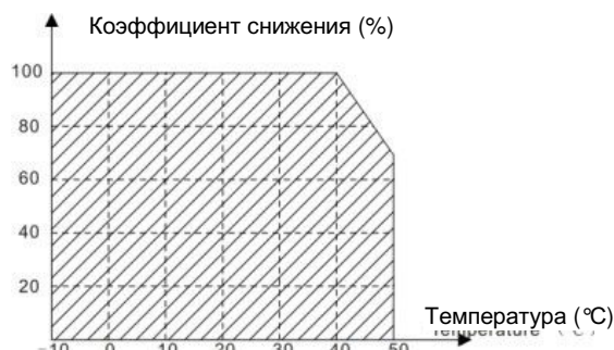
Рисунок 3-2. Снижение номинальной мощности преобразователя частоты GD200 в зависимости от температуры окружающей среды.
