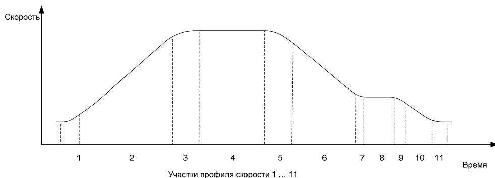
Рисунок 24. Профиль скорости с использованием малого хода.
