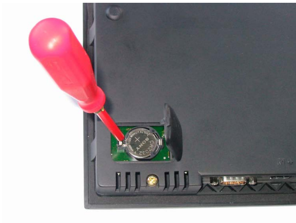
Рис. 11-18 Замена буферной батарейки панели управления шкафного устройства
