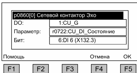
Рис. 5-39 Соединение эхо главных контакторов или силовых выключателей с цифровым входом 6
