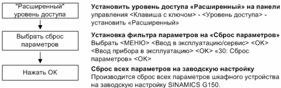
Рис. 5-40 Порядок сброса параметров до заводских настроек при помощи AOP30
