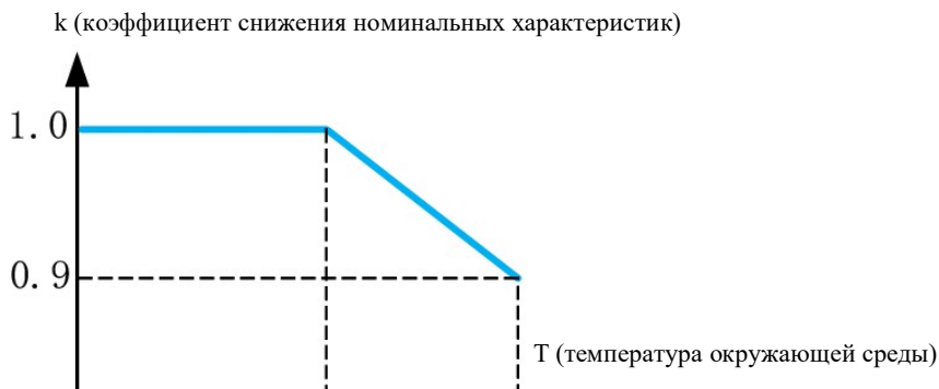
Рисунок 2-3 Кривая зависимости силы тока инвертора от температуры
