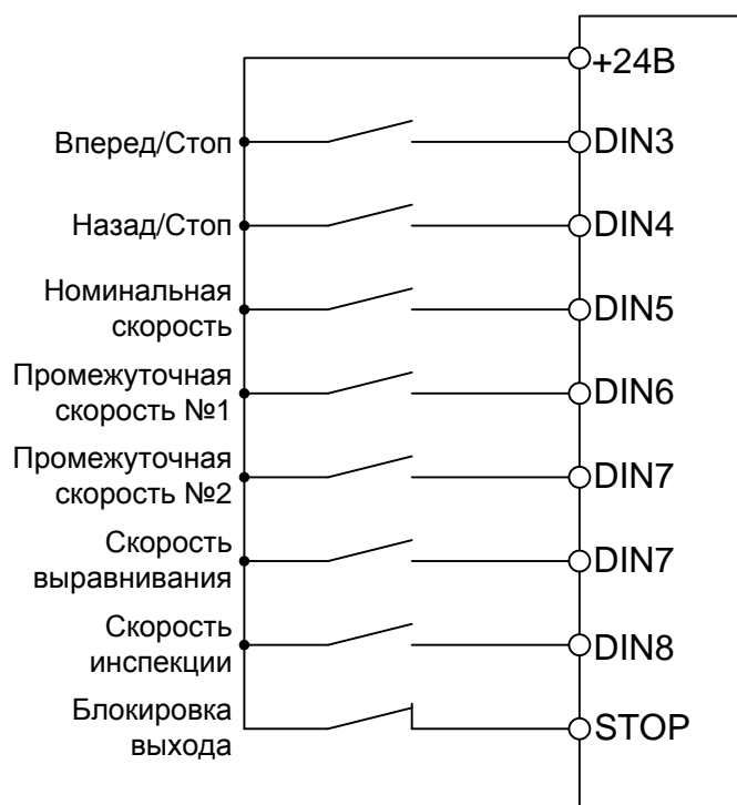
Рисунок 9.6 — Пример схемы управления электроприводом в системе «Лифт» (подъемник)
