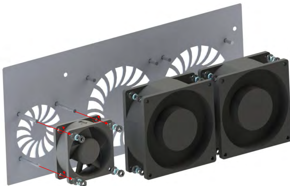
Рисунок 12.6 — Снятие вентиляторов электроприводов AT24-30К...37К-380-1****
