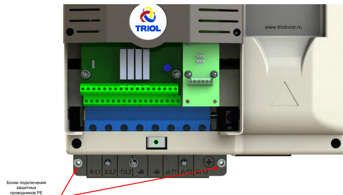
Рисунок 5.15 — Внешний вид электропривода без дополнительной развязывающей панели
