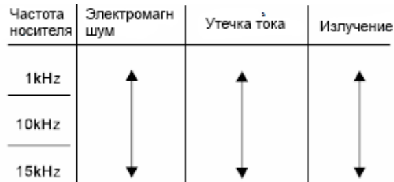
Рисунок 6.2— Влияние частоты ШИМ.
