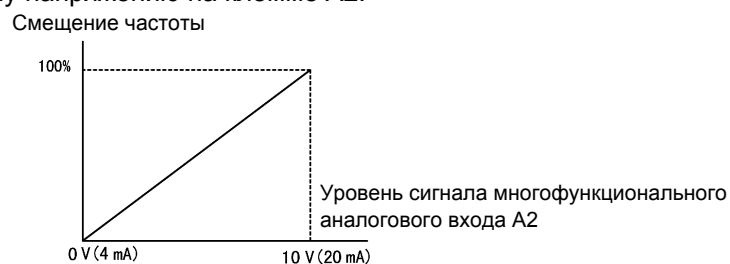
Рис. 6.32 Регулировка смещения частоты (с помощью входа А2)
