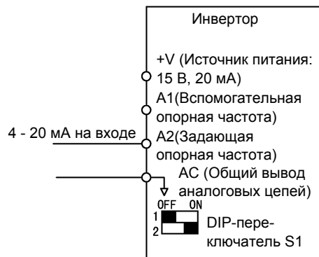
Рис. 6.8 Использование сигнала тока для опорной частоты
