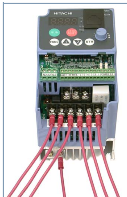
К источнику питания Заземление на массу К электродвигателю
