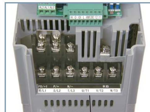
Клеммная колодка подключения питания и электродвигателя
