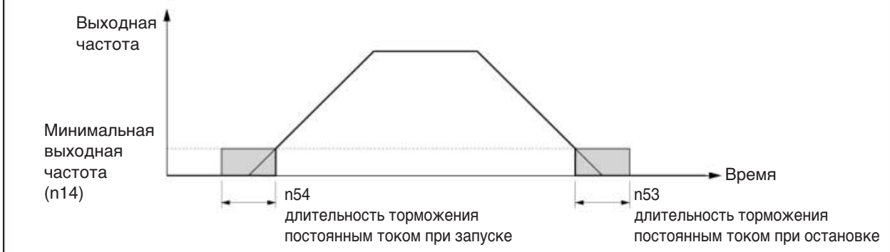
Управление торможением постоянным током
