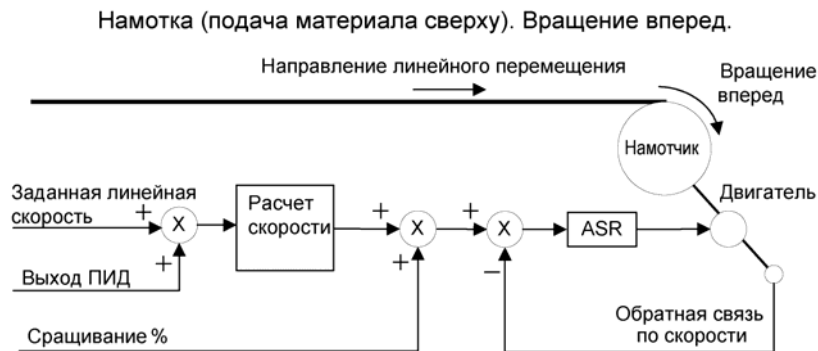
Рис 1. Намотка рулона при подаче материала сверху.
