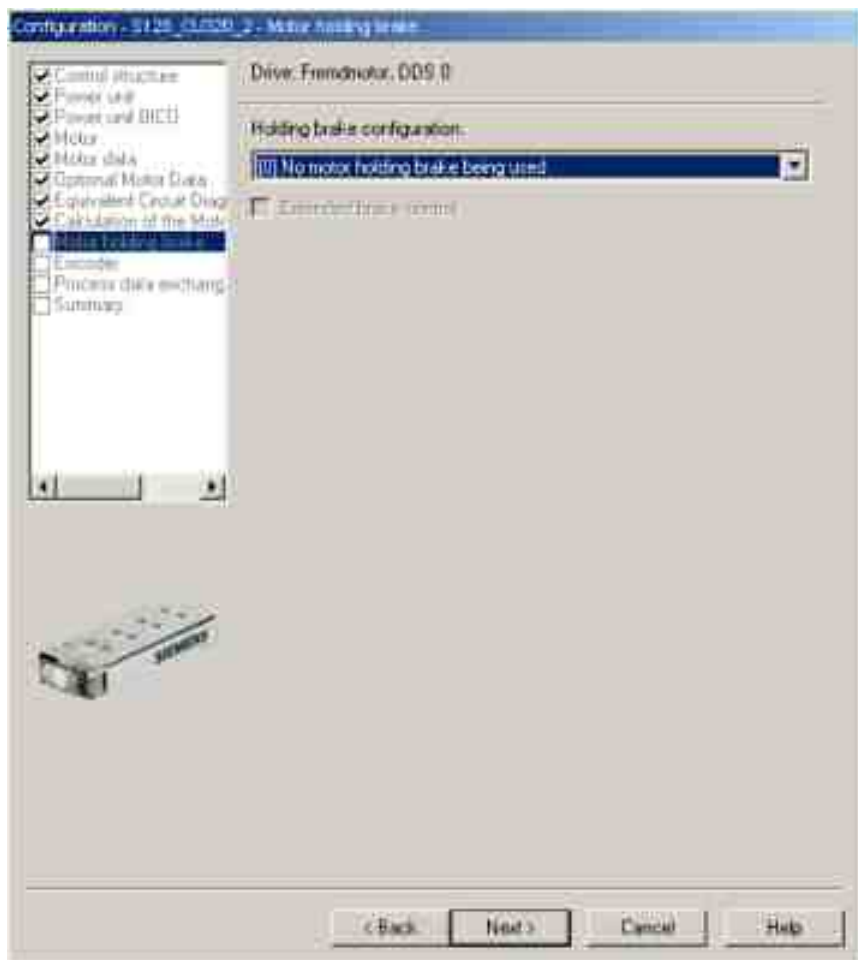
Изображение 3-48 Форма для конфигурации стояночного тормоза двигателя
