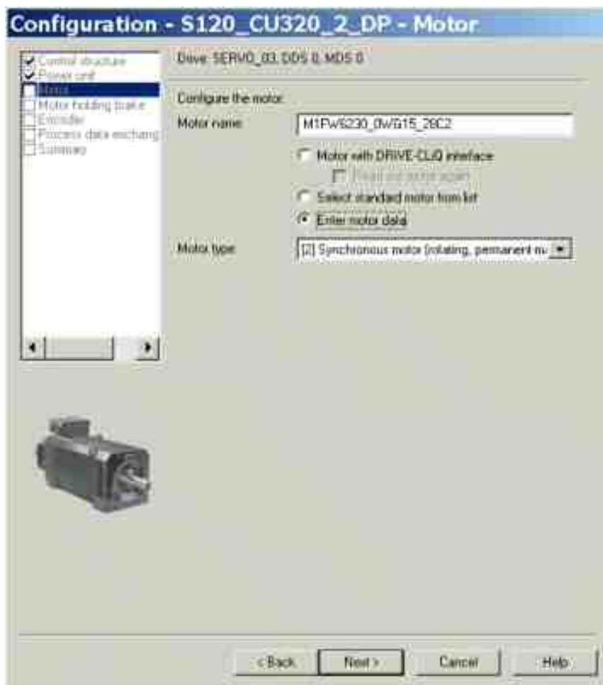
Изображение 3-72 Окно конфигурации двигателя – настройки двигателя стороннего производителя
