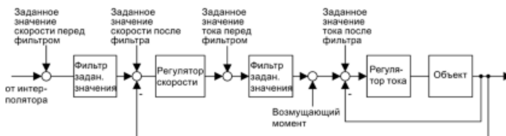
Изображение 4-1 Точки подключения генератора функций
