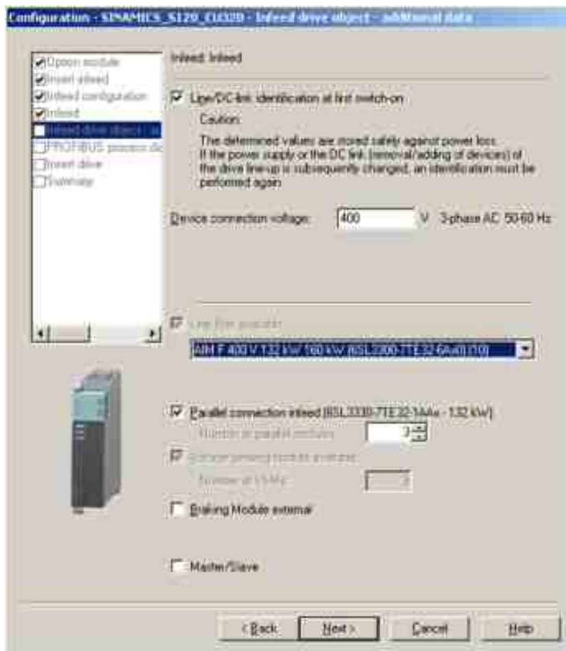
Изображение 3-34 Пример параллельного включения 3 активных модулей питания (формат «шасси»)
