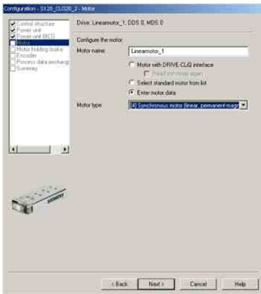
Изображение 3-43 Окно конфигурации двигателя – настройки двигателя стороннего производителя
