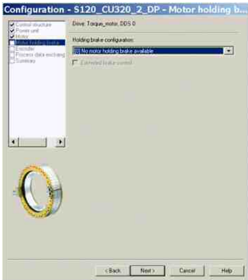
Изображение 3-77 Форма для конфигурации стояночного тормоза двигателя
