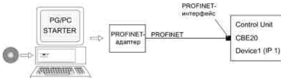
Изображение 3-19 Соединение программатора с целевым устройством через PROFINET (пример)
