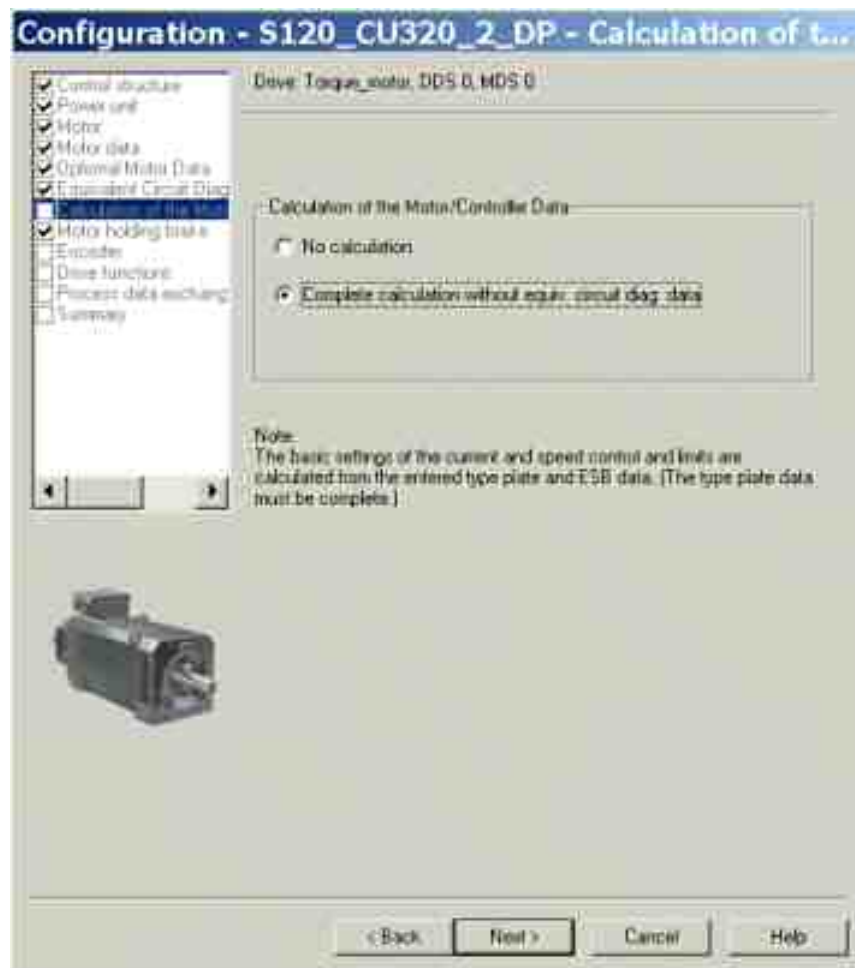
Изображение 3-76 Окно расчета данных двигателя/регулятора
