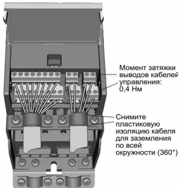
Рисунок 3.8: Смонтируйте кабели управления. См. главу 6.2
